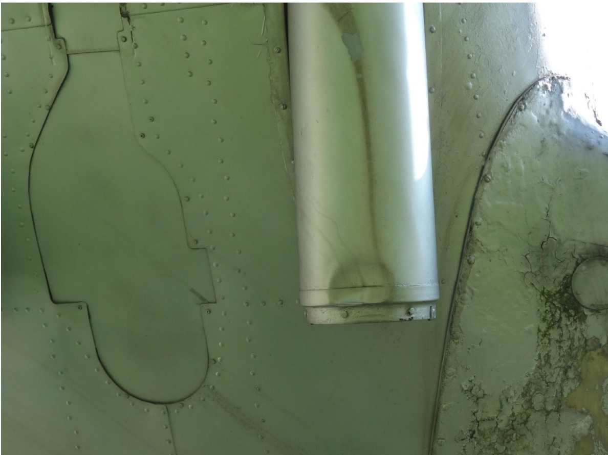
unzählige Dellen an den Flächen und am Rumpf
