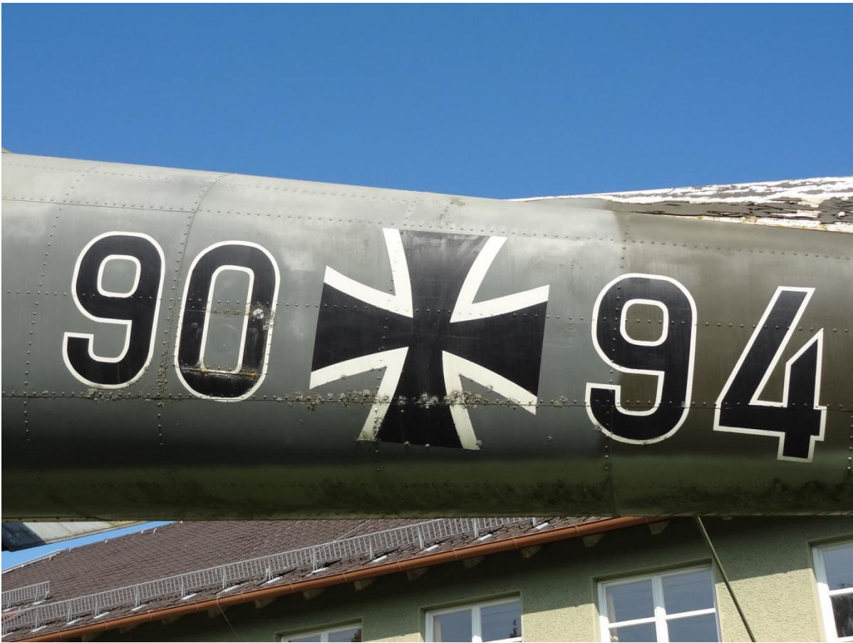
Staub, Moos, Algen und Flechten überzogen die Flugzeugoberfläche
