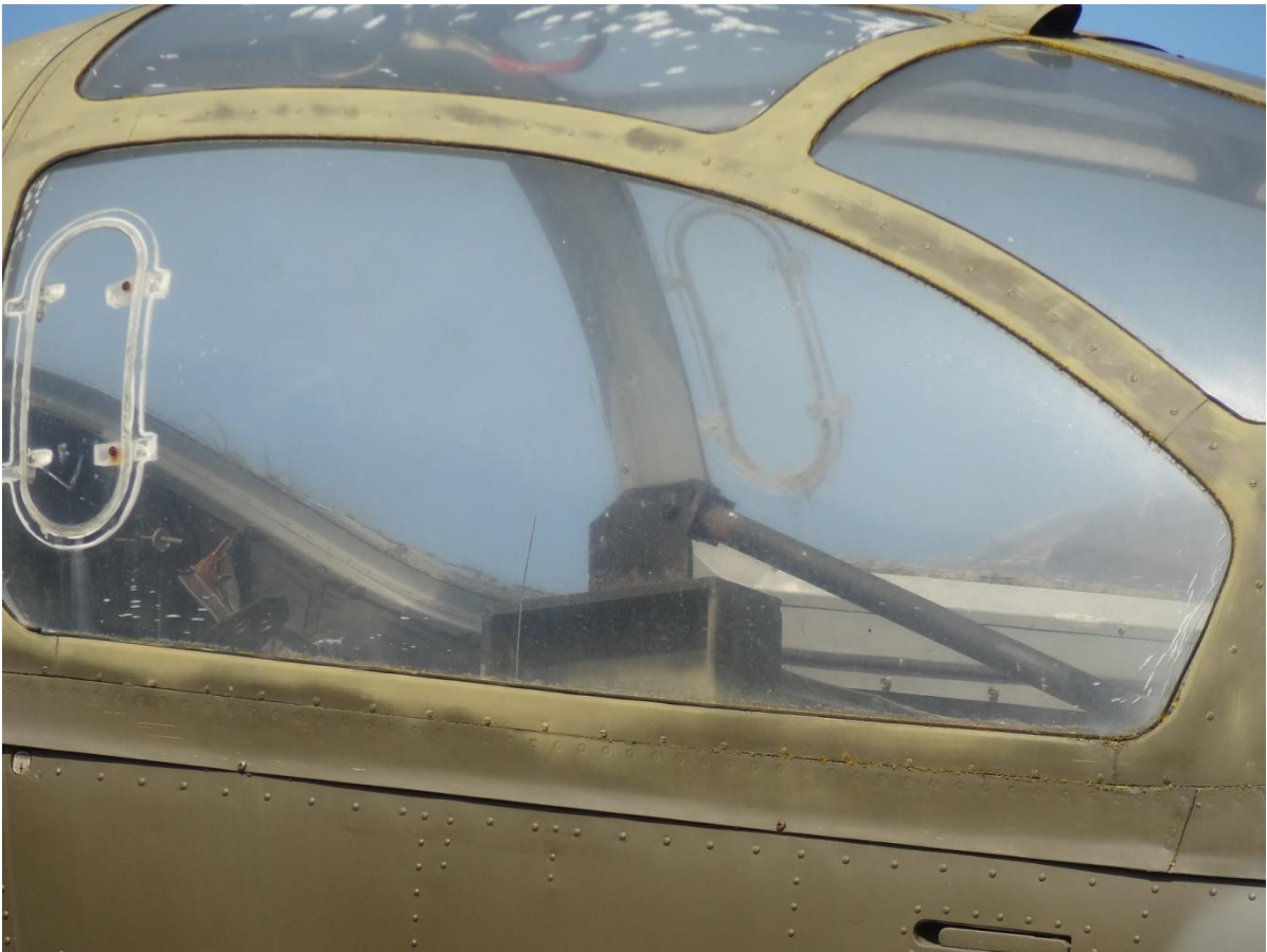
Risse und Löcher im Cockpit Glas, genug Stellen für einen Wassereintritt
