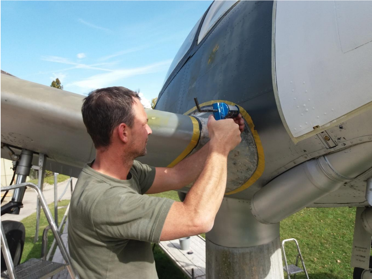
Abdichten im Bereich der GFK Flächen – im Bild Ralf Badstöber
